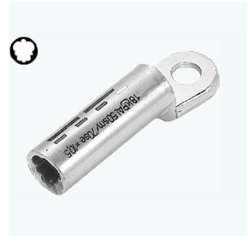
Al-Presskabelschuhe werden mit Presszusatz gefüllt und in Folie eingeschweißt geliefert. Bei der Montage ist darauf zu achten, dass bei blanken Al-Presskabelschuhen die gerillte Laschen-Unterseite vor dem Anschluss mit einer Drahtbürste gereinigt wird.
