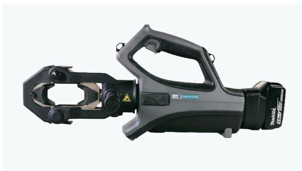
Mit einer Kraft von 134 kN und einem Hub von 50 mm verarbeiten die InLineBox-C15 und InLineBox-C15-O mühelos Kabelschuhe und Verbinder bis 600 mm<sup>2</sup> nach DIN.
